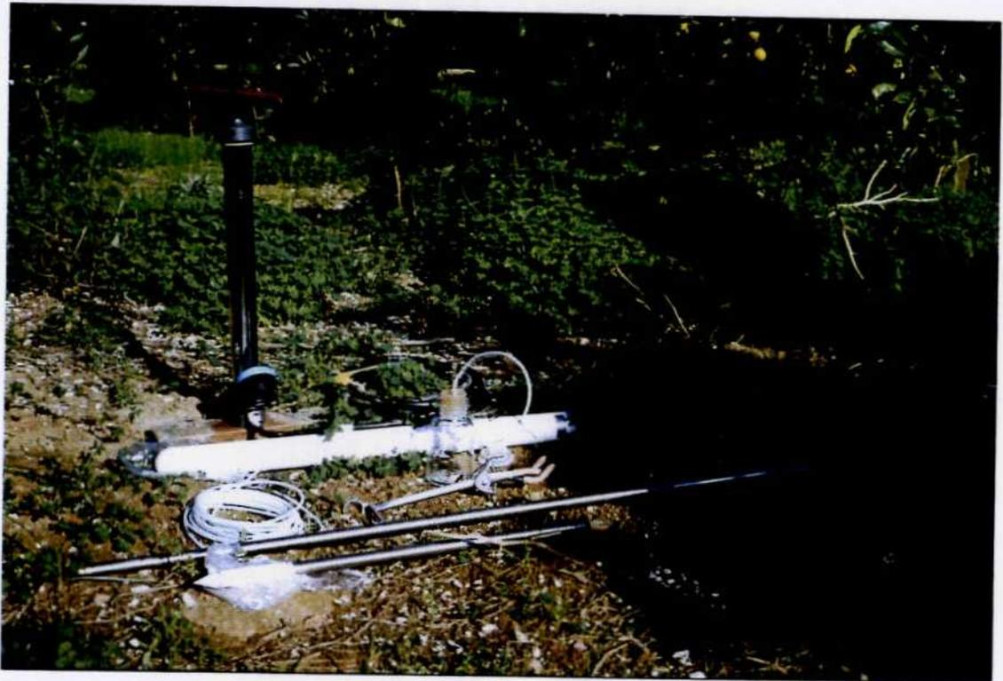
Figura 4.2. Equipos de muestreo de solución intersticial del suelo.
